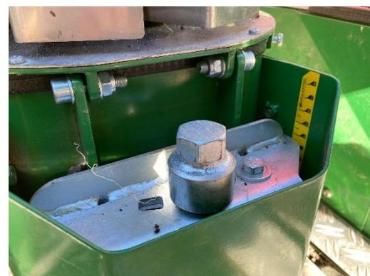
*Réglage en hauteur des roues de pression par un hexagone de 24 et inclinaison des roues l'une par rapport à l'autre par une vis M13*
