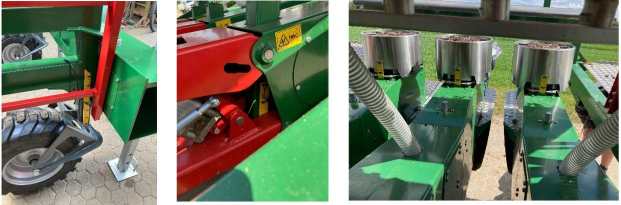
*Echelles pour les profondeurs de réglage sur la roue de guidage, la roue de jauge et le soc de plantation*
