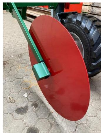
*Disque de protection avec capteur de vitesse de déplacement*
