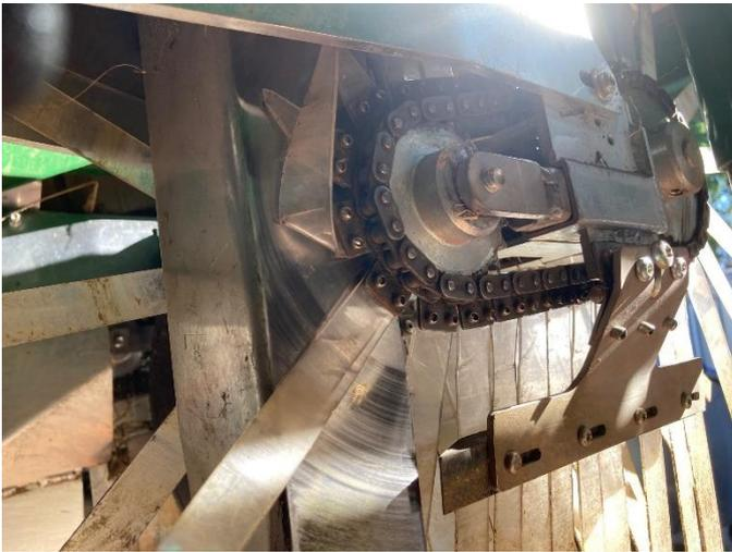
Cas extrême : la chaîne à lamelles s'est solidement calée comme sur la photo. Les différents doigts en plastique sont fabriqués en polycarbonate. Ils sont extrêmement robustes et peuvent être redressés. Mais il y a aussi des limites. Il peut arriver qu'ils se brisent ou se tordent de manière irréparable. Dans l'intervalle, il est possible d'enlever la lamelle concernée et de poursuivre la plantation. Mais à moyen terme, la lamelle ou la chaîne entière doit être remplacée.
