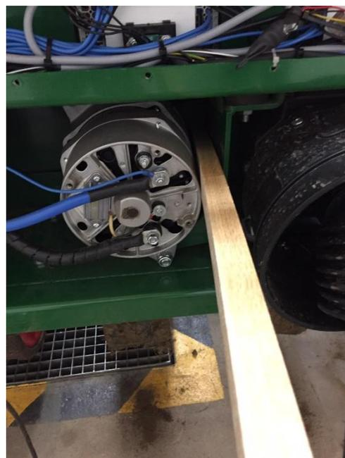
*Retendre la courroie trapézoïdale de l'alternateur*
