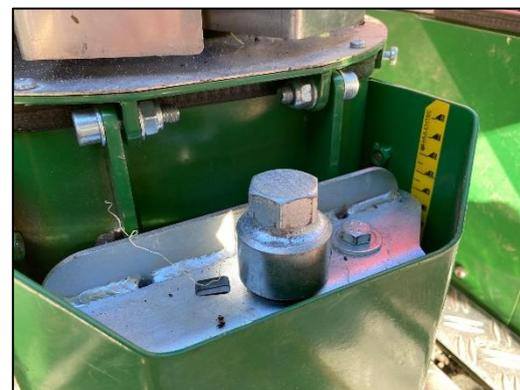
*Höhenverstellung der Andruckräder durch 24 er Sechskant und Schrägstellung der Räder zueinander durch M13 Schraube*
