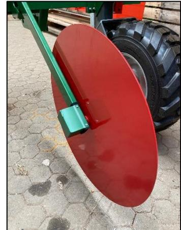
*Schutzscheibe mit Sensor für Fahrgeschwindigkeit*
