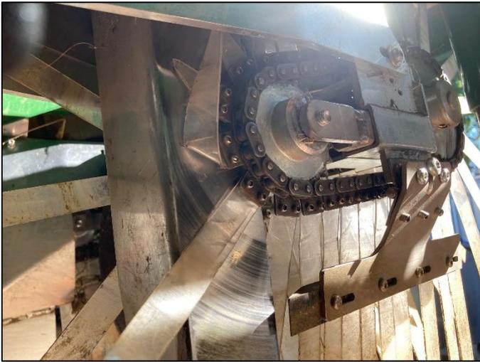
*Blockade durch feststeckende Lamelle*
