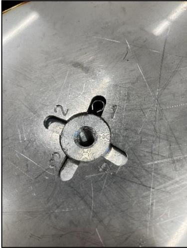
Die Position der Revolverpause über dem Fallrohr wird über die Anschraubposition der Revolvertrommel definiert. Der Deckel der Revolvertrommel hat bei neueren Versionen bereits vier vorgefräste Positionen eingearbeitet. Sie definieren die Position des Öffnens der Becherklappen. Je nach Topfform bzw. Einstellung der Schließklappen des Revolvers, wird damit die Pflanze immer mittig über dem Fallrohr abgeworfen.
