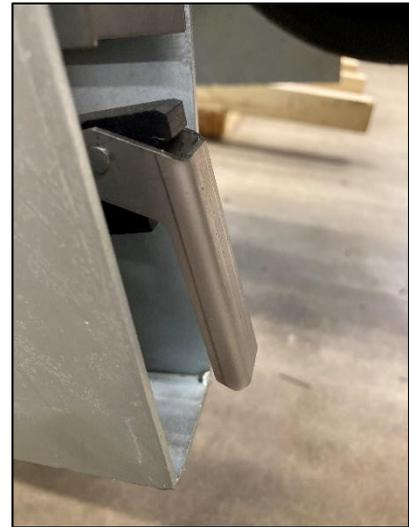
*Die Schieberklappe – dahinter befindet sich eine Verstellerschraube*
